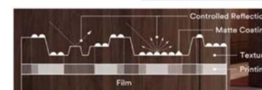
**3MTM DI-NOCTM** ha incorporato il sistema adesivo brevettato **3MTM ComplyTM**. Le pellicole Comply hanno dei microcanali nell'adesivo che permettono all'aria di uscire e consentono applicazioni senza bolle. I rivestimenti **3MTM DI-NOCTM** sono marcati CE secondo la direttiva dei prodotti da costruzione 89/106/EEC e testati secondo la EN 15102: 2008.
